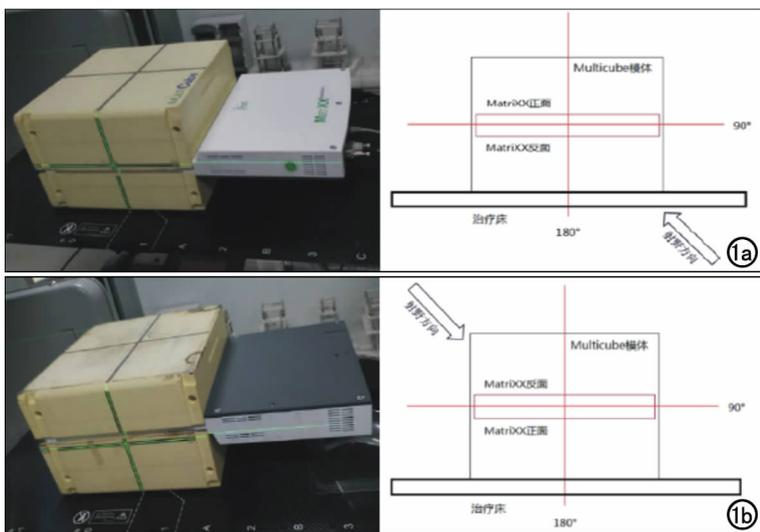
图 1 方野照射时剂量测量方法。a) 测量穿过治疗床结合部的射线; b) 测量避开治疗床结合部的射线。
